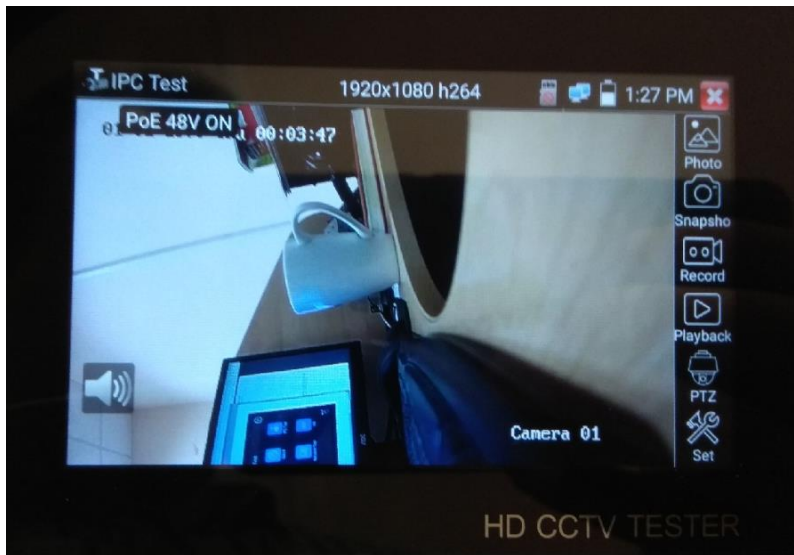
Рис. 17 Пример успешного подключения IP-видеокамеры к тестеру
