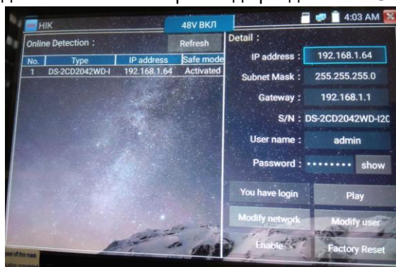
Рис. 23 Приложение HIK для теста IP-видеокамер производства HIKVISION
