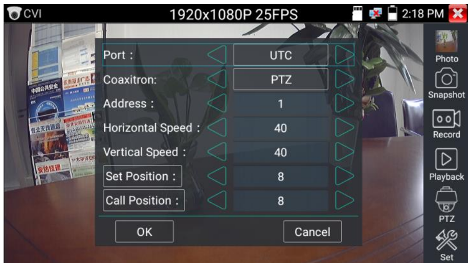
Рис.9 Настройки PTZ для видеоканер с UTC
