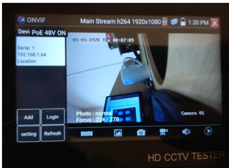
Рис. 18 Пример успешного подключения IP-видеоканеры к тестеру через Onvif
